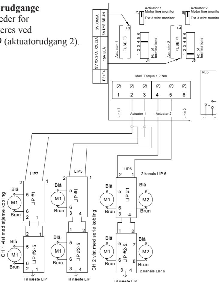
**Eksempel på linieovervågning med 2 x jumpere (fra software version 499):**
